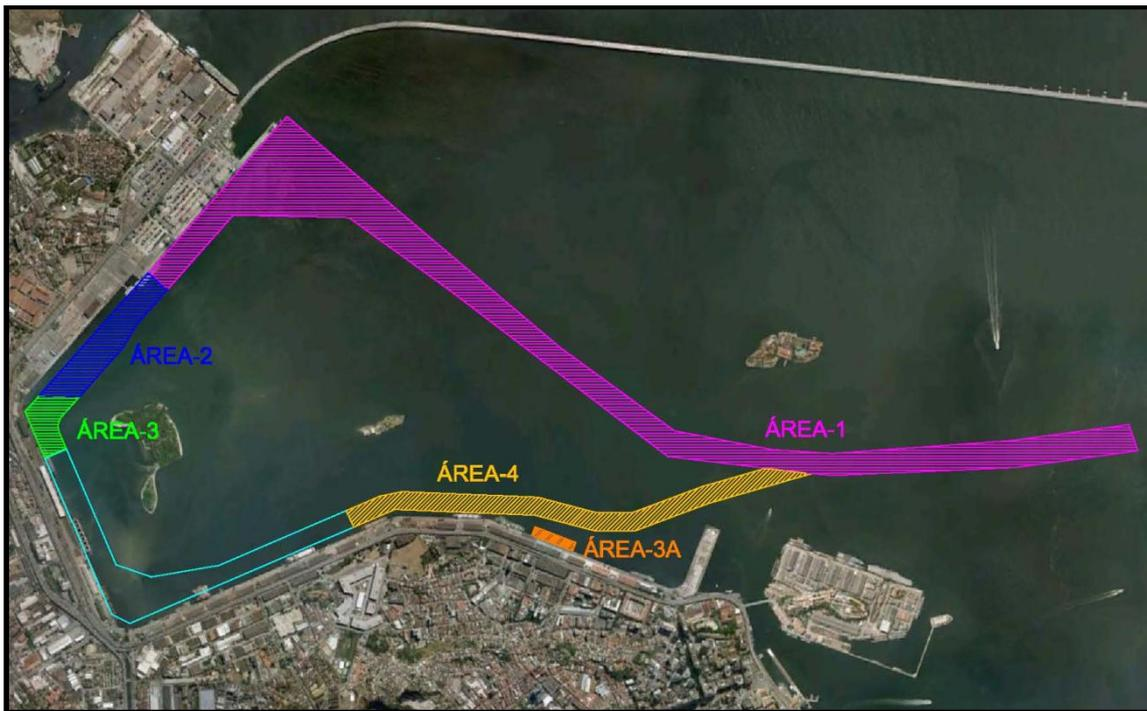
Figura 6 - Ilustração das áreas dragadas sobre a imagem de satélite da região do Porto do Rio de Janeiro. (Fonte: AECO - Área de Engenharia Costeira e Oceânica, 2011)
