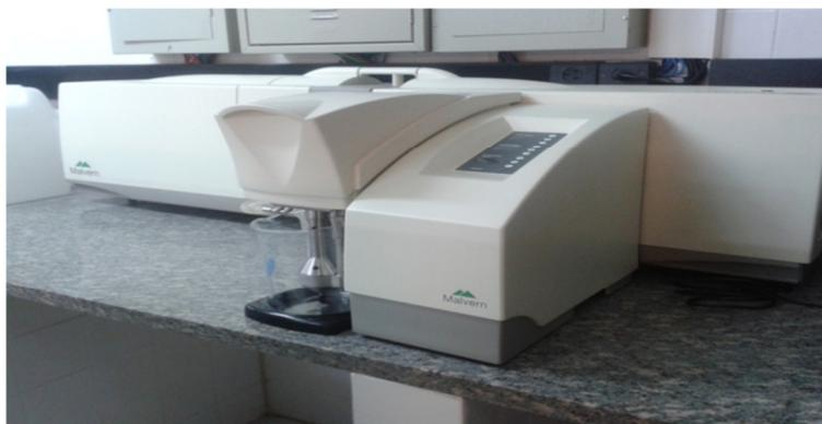
**Figura 21:** Equipamento de difração a laser utilizado no trabalho: Mastersizer 2000, da Malvern®. O equipamento possui uma unidade de dispersão aquosa, onde os sedimentos são colocados no béquer com aproximadamente um litro de água destilada, de forma que seja possível obter a curva de distribuição granulométrica.
