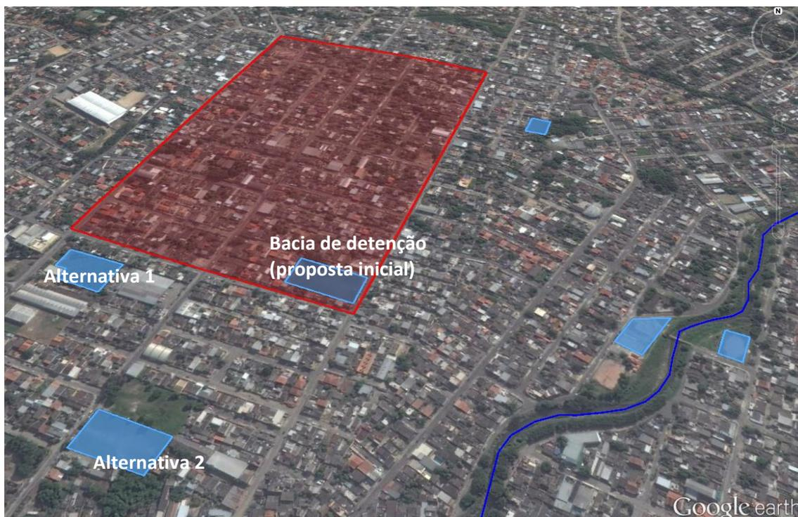
**Figura 38.** Áreas potenciais para construção de bacias de detenção
