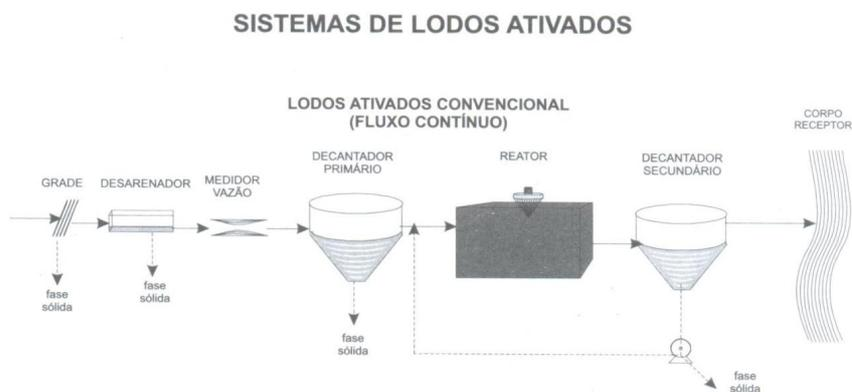
**Figura 5:** Sistema de lodo ativado convencional
