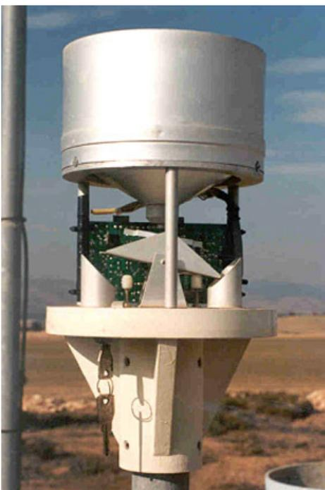
Figura 11 – Estação Pluviométrica
