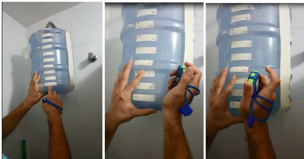
*Figura 30, 31 e 32-Medição da vazão no chuveiro.
