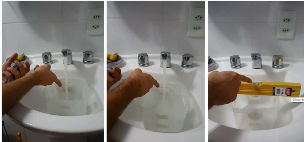
*Figura 27, 28 e 29-Medição da vazão das torneiras do lavatório.
