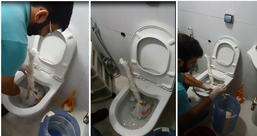
*Figura 33, 34 e 35-Medição do volume da descarga.*
