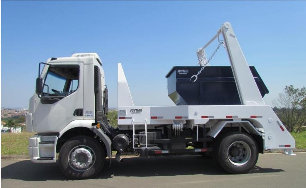
Figura 22 - Caminhão poliguindaste com caçamba tipo Dempster de 7 m<sup>3</sup>
