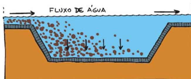
**Figura 13:** Esquema ilustrativo: Lagoa de Decantação. Fonte: TABATA e DA SILVA, 2012.
